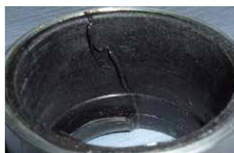
Hier kann man sehr gut sehen das das Dichtmittel seine Aufgabe erfüllt. Natürlich wurde überschüssiges Dichtmittel noch entfernt und die innere Oberfläche geglättet. Mit einem neuen O-Ring für die innere Abdichtung kann dann wieder eingebaut werden. Alles is' gut.
