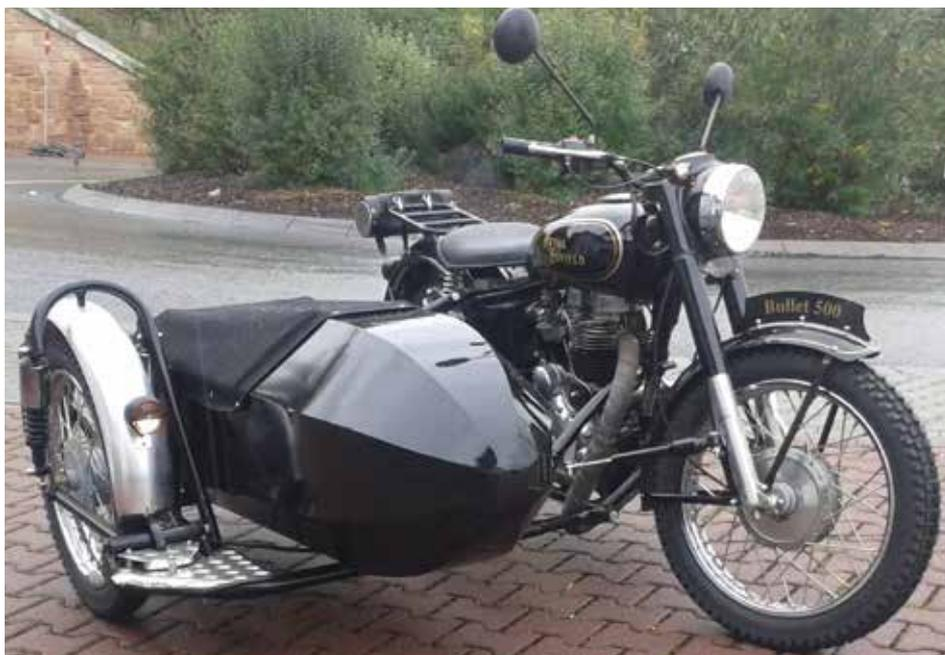
Mit einer **Spurbreite von 1150 mm** hat Vitus Bülter einen guten Kompromiss zwischen Wendigkeit und Hebel gegen zu frühes Steigen des Beiwagens gefunden. Allenfalls der **Vorlauf von 310 mm** und die **Vorspur 20 mm** bremsen das Gespann bauartbedingt doch etwas mehr ein, bewegen sich aber im üblichen Rahmen dessen was für ein
